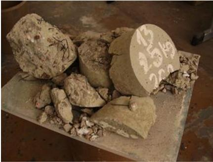
Fig. 8: Cylinder „25“ (max. 1049 °C)
