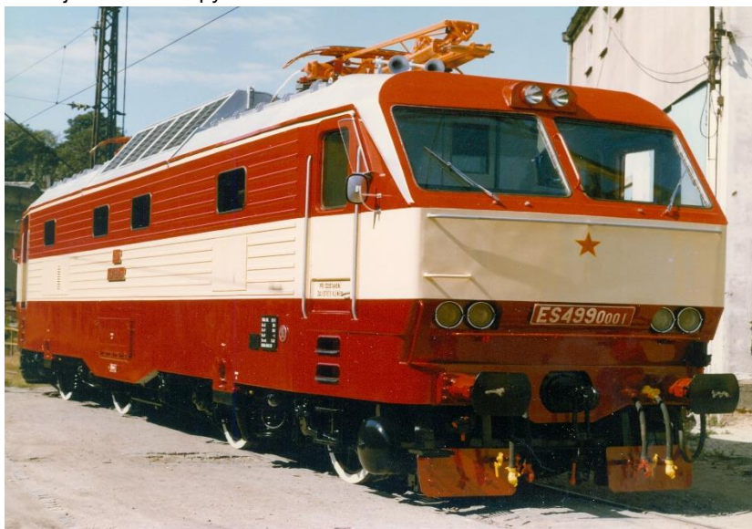
Obr. 2 Dvousystémová elektrická lokomotiva pro ČD projektovaná na rychlost 200 km/h
