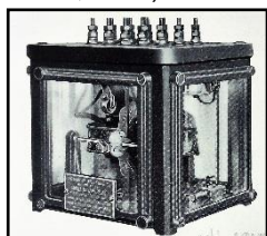
Obr. 8 a 9 Segmentové relé typ M15 a reléový sál v roce 1934 (The Union Switch & Signal Co, USA)
