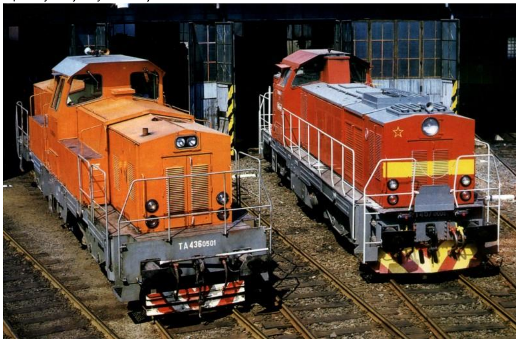
Obr. 34 Hybridní lokomotiva, označená již TA 436.0501, spolu s porovnávanou motorovou lokomotivou řady T 457.0 (730) v olomouckém depu
