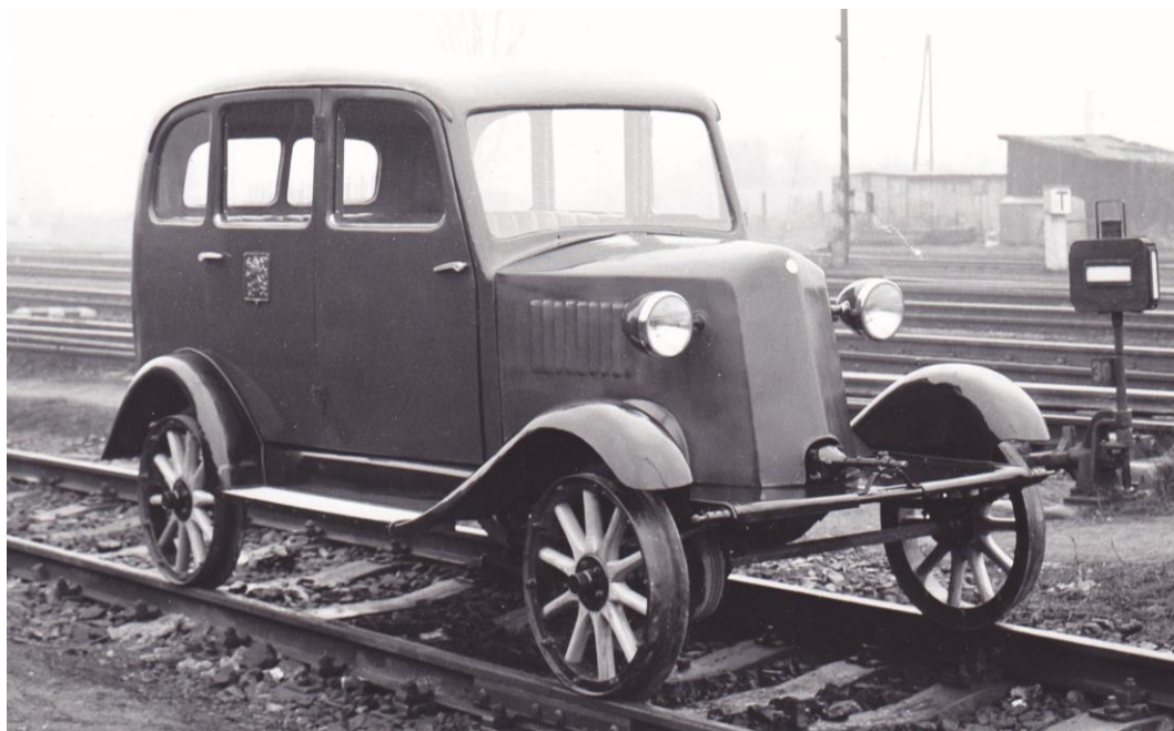
Obr. 1 Drezíny T 15/30 vyráběla v letech 1932 až 1938 Tatra Kopřivnice. Foto Josef Kývala, archiv ČD Olomouc
