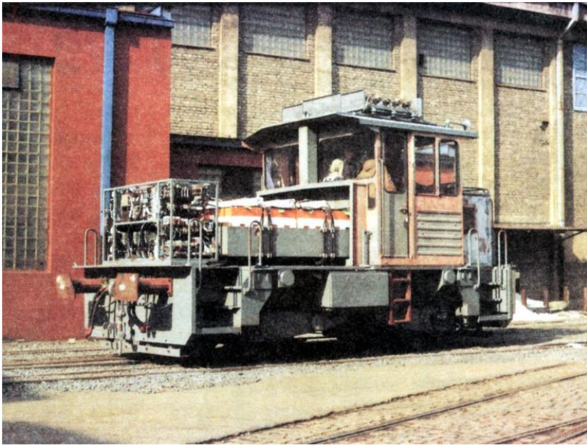
Obr. 25 Akumulátorová lokomotiva A 219.0001 při prvních zkouškách v závodě ČKD Lokomotivka v roce 1993. Dodnes železniční průmysl produkuje motorové lokomotivy na principu počátků motorizace.
