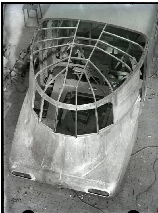
Obr. 11 Stavba skříňe motorového vozu M 290.0
