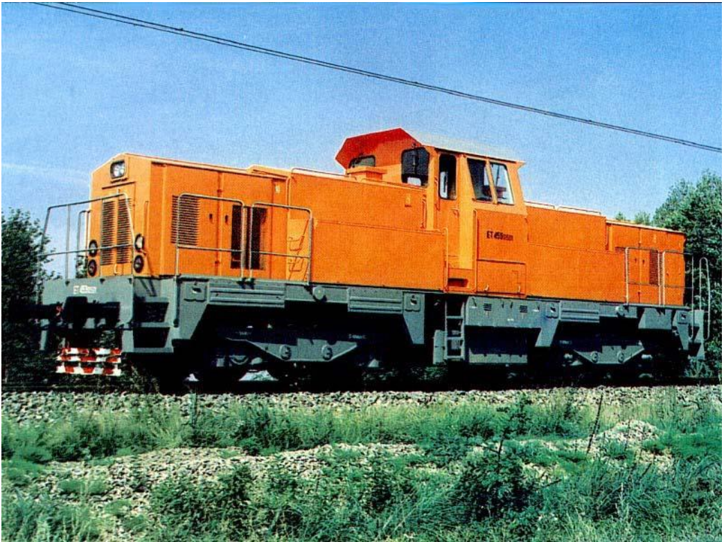
Obr. 30 Hybridní lokomotiva z ČKD Praha vyjela pod označením ET 459.0501
